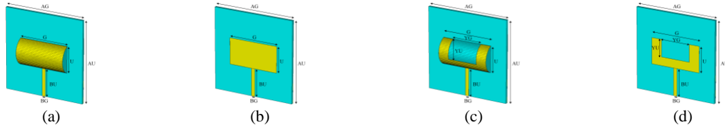
Şekil 1. Benzetim ortamında oluşturulan (a) kavisli (KMA), (b) düz (DMA), (c) yarık barındıran kavisli (YKMA) ve (d) yarık barındıran düz MA (YDMA) tasarımları.
