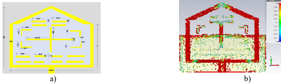
Şekil 2 Anten 3'e ait şematik gösterim ve 2.4GHz'de yüzey akım dağılımı
